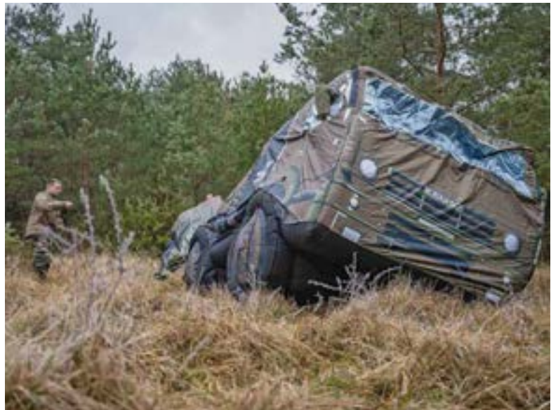
Les leurres sont principalement fabriqués en soie synthétique et gonflés à l'aide de pompes. Ils pèsent entre 25 et 90 kilos, et il faut deux à quatre personnes pour les manipuler.
