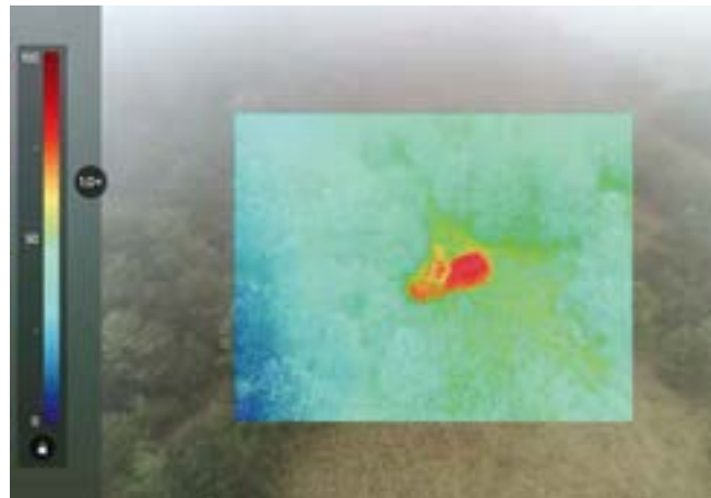
Image d'un leurre gonflable avec signature thermique captée par un drone. Le moteur utilisé pour le gonfler dégage une chaleur pouvant tromper les capteurs infrarouges de l'ennemi.
