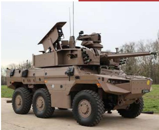
L'Engin Blindé de Reconnaissance et de Combat (EBRC) Jaguar est un véhicule de reconnaissance à 6 roues motrices conçu par Nexter, Thales et Arquus. Destiné à remplacer le VAB HOT, l'AMX 10 RC et l'ERC 90 Sagaie, il a été conçu pour pouvoir s'intégrer, entre autres, dans des combats en zone urbaine ou montagneuse. A l'horizon 2030, 300 Jaguar équiperont les brigades dotées jusqu'à présent des véhicules cités supra.
