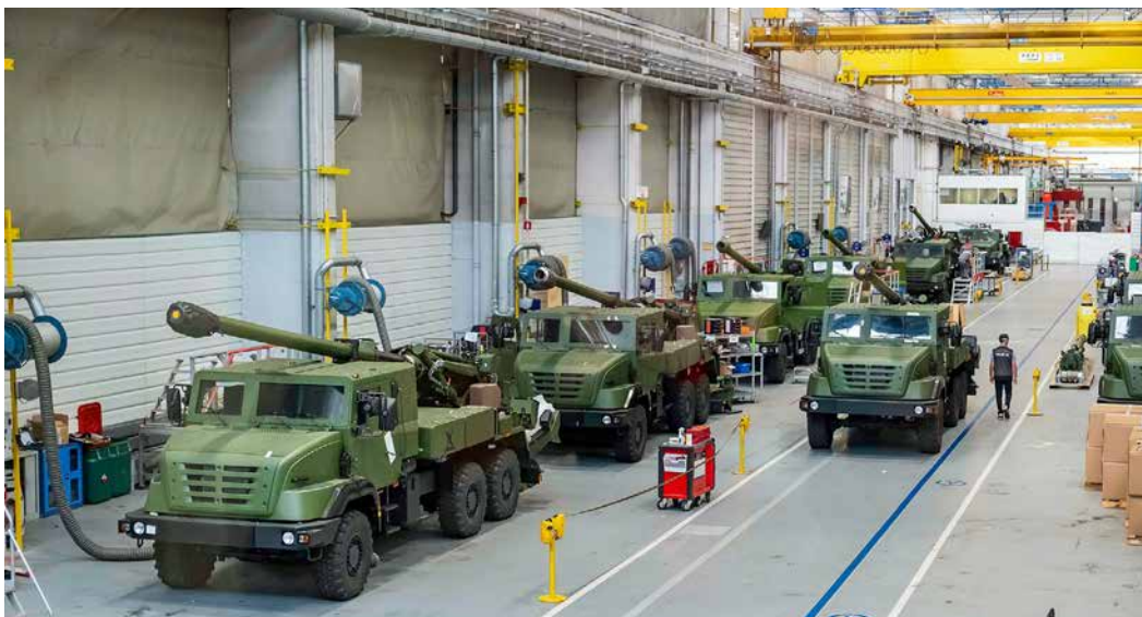
Les Caesar sont en cours d'assemblage avant d'être livrés aux unités de l'armée de Terre.
